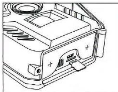
Impostare l'interruttore in posizione "ON" e la spia lampeggerà 1-2 volte. Quando si spegne, la fototrappola passa allo stato di rilevamento PIR.
